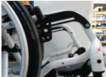
Freno std con pletina no compatible con anclajes superior Attitude
